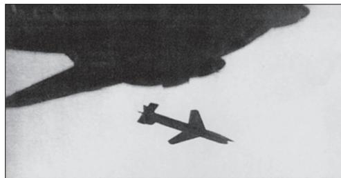
Testabwurf der Hs-117 von einer Bombertragfläche.
