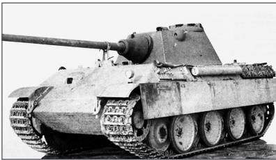
Der modernisierte *Panther*, *Version F*. Der Panzerkampfwagen wurde gründlich modernisiert, die Änderungen betrafen keineswegs nur den Turm. Er sollte auch mit einem neuen Antriebssystem sowie u. a. Vorrichtungen zur wirkungsvollen Feuerführung nachts und während der Fahrt ausgestattet werden. Es handelte sich also um Änderungen, die den Panzerkampfwagen für die nächste Generation qualifizierten. (Archiv)
