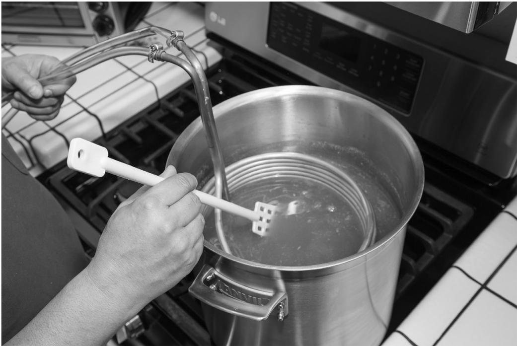
Abbildung 1.13: Ein Eintauchkühler wird in den Braukessel gehalten.
