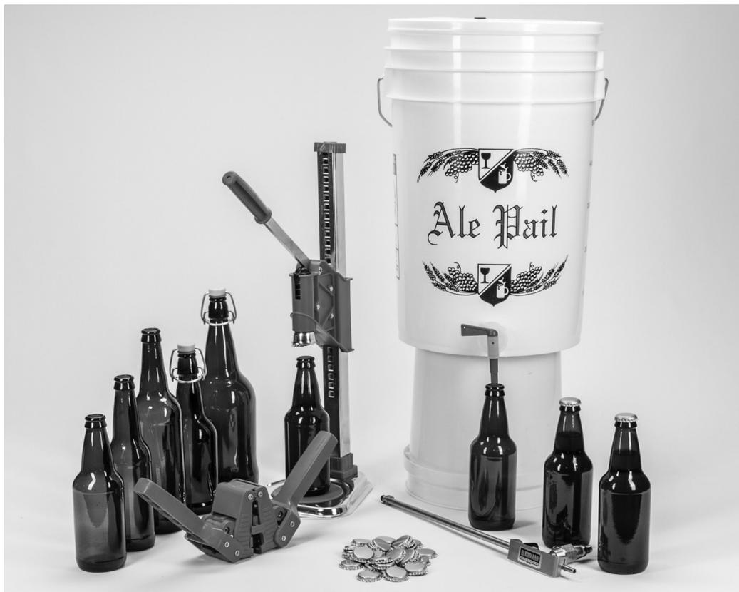
*Abbildung 1.18: Die Ausstattung für das Abfüllen des Bieres. Sie benötigen ein Verschlussgerät, Kronkorken bzw. Bügelverschlussflaschen und entweder eine Abfüllpistole oder einen Abfülleimer mit Ablasshahn und ein Abfüllröhrchen.*
